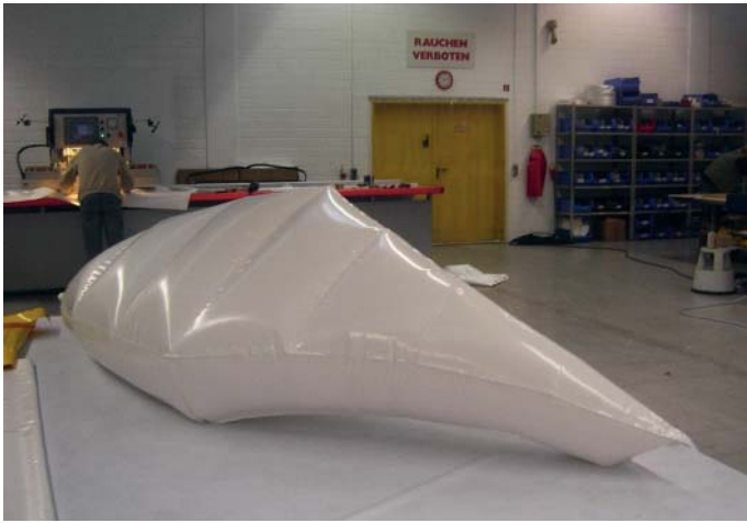
Geschweißte Verbindungen: Kissen aus besonders transluzentem Polyester/ PVC Gewebe (Foto: Planex GmbH)
